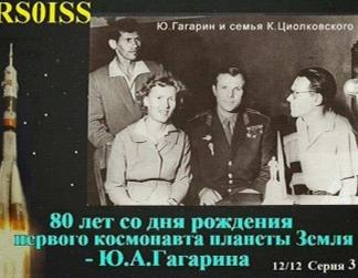
Las transmisiones se hicieron en la frecuencia de 145.800 MHz en la banda de 2 metros, usando SSTV con el modo PD180. Activar "Allways show RX viewer" o usar "Picture viewer" para exhibir con resolución 640 x 496.
